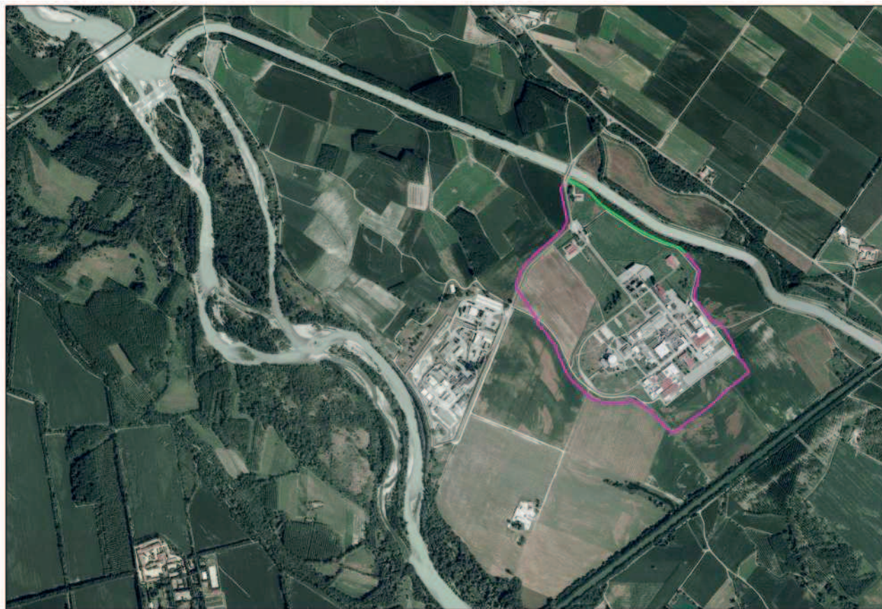
Fig.2 - inquadramento dell'area su Ortofoto AGEA 2018: le linee verde (muro in c.a.) e rosa (rilevato arginale) indicano l'intervento in progetto
